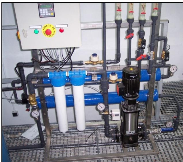
**Figura 9.** Filtración con membranas de osmosis Inversa en planta UJI.
